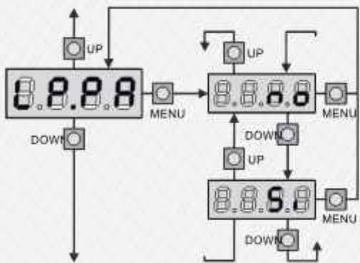
فلاشر همیشه در زمان حرکت درب ها چشمک می زند و در زمانیکه درب باز مانده چشمک زدن آن متوقف می گردد. با ورود به گزینه **LPPA** و تنظیم آن روی حالت **Si** فلاشر در زمان باز ماندن درب هم چشمک خواهد زد.
