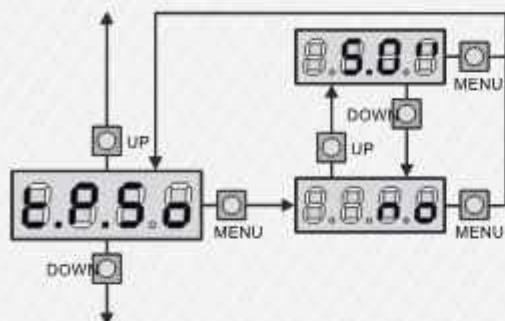
درب های در هنگام بسته شدن با یک سرعت مطلوبی حرکت می کنند. اگر با همان سرعت درب ها بسته شوند صدای برخوردي بین آنها اتفاق می افتد. برای برطرف کردن این مشکل من باسیست حرکت کنندشونده در هنگام بسته شدن را تنظیم نماییم تا درب های در چند ثانیه آخر به آرامی بسته شوند. در حالت مطلوب آنرا روی ۴ ثانیه قرار دهید.
