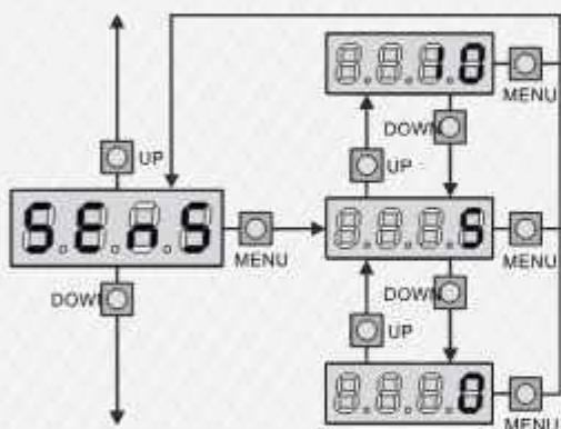
در طول مسیر حرکت جک ها در صورتیکه مانع در سر راه درب ها قرار گیرد ابتدا جک ها فشاری را به مانع اعمال کرده و در صورت رد نگردن آن متوقف خواهد شد. جهت تنظیم این حساسیت وارد گزینه **SEnS** می شویم. حساسیت از صفر تا ده قابل تنظیم است. هر چقدر به صفر نزدیکتر بشویم این حساسیت کم و هر چقدر به ده نزدیکتر بشویم این حساسیت زیاد تر می شود.
