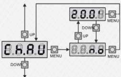
اگر پس از بازگردان درب توسط ریموت کسی از جلوی چشمی ها رد نشود در نتیجه درب باز خواهد ماند. در این دستگاه مرکزی امکان تعییه شده است که در صورت بازشدن درب توسط ریموت، حتی اگر کسی از جلوی چشمی هارد نشود باز هم درب پس از مدت زمان مشخصی بسته خواهد شد. با ورود به گزینه **ChAU** می توانید مدت زمان بسته شدن اتوماتیک را بدون عبور کردن از چشمی ها تنظیم نمایید.
