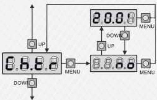
تصویر کنید کاربر جلوی درب پارکینگ دکمه ریموت را فشار داده و درب باز می شود. بدیهی است که ابتدا از جلوی چشمی هارد شده وارد پارکینگ می شود. با فعال کردن بسته شدن اتوماتیک، پس از ردشدن از جلوی چشمی ها ثانیه شمار بر راه افتاده و پس از مدت زمان مشخصی درب بسته خواهد شد. با ورود به گزینه **Chtr** می توانید مدت زمان بسته شدن اتوماتیک را تنظیم نماییم.
