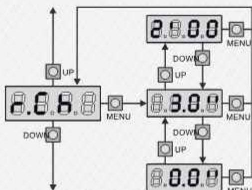
تاخیر زمانی در هنگام بسته شدن باعث میشود که درب هادر هنگام بسته شدن در بین راه به همدمیگر برخورد نکند و این عملکرد سبب ضربه نخوردن دولنگه خواهد شد.
