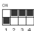
دیپ سوئیچ ها را طبق شکل تنظیم و کلید OK را فشار دهید. برای تنظیم سرعت موتور طبق جدول زیر عمل شود.
