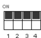
دیپ سوئیچ ها را طبق شکل تنظیم و کلید OK را فشار دهید. یکبار کلید BP1 فشار داده شود ، LED دوبار خاموش و روشن شده و مقادیر سیستم به مقدار اولیه سازنده برگردانده می شود. در صورتی که قبل از این کار برنامه ریزی شده باشد ، تمام برنامه ریزیهای قبلی سیستم بجز معرفی ریموت کنترل باید از نو تکرار شود.
